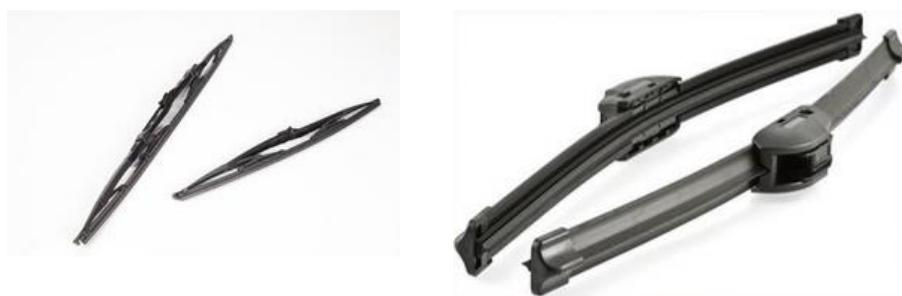
FIGURE 2 : ESSUIE-GLACE EN U (A GAUCHE), ESSUIE-GLACE FLAT BLADE (A DROITE)
